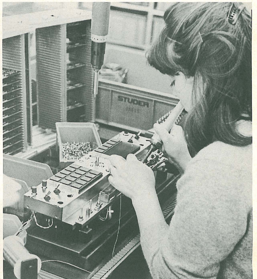
Eine Mitarbeiterin montiert die komplette Abstimmereinheit in einer Vorrichtung (7) und prüft die Funktion und die Reihenfolge des kHz- und MHz-Rasters mit einem Halbautomaten.
