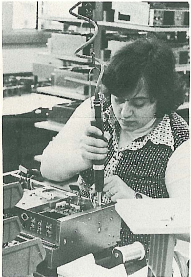
Die Montage der letzten drei grossen Baugruppen erfolgt in einem Endmontageplatz (9, 10), an dem anschliessend sogleich die ersten Funktionstests durchgeführt werden (11).
