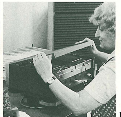
Ein abschliessender Funktionstest (16) und der Einbau ins Gehäuse (17) beenden die Endmontage und Endprüfung des Tuners B760.
